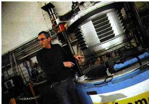
Après sa construction, le prototype est testé dans un caisson hyperbar pour vérifier sa résistance à la pression.
