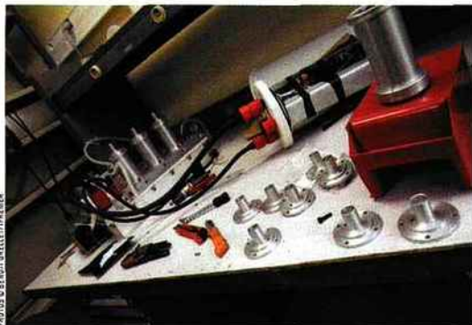
Après sa construction, le prototype est testé dans un caisson hyperbar pour vérifier sa résistance à la pression.
