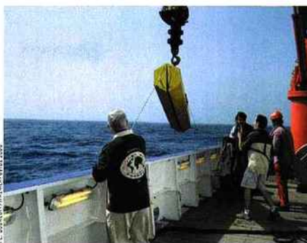
Un caisson protège le flotteur lors de son largage en pleine mer.
